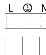
Fig. 6: Utdragbar kopplingsplint för nätanslutning
